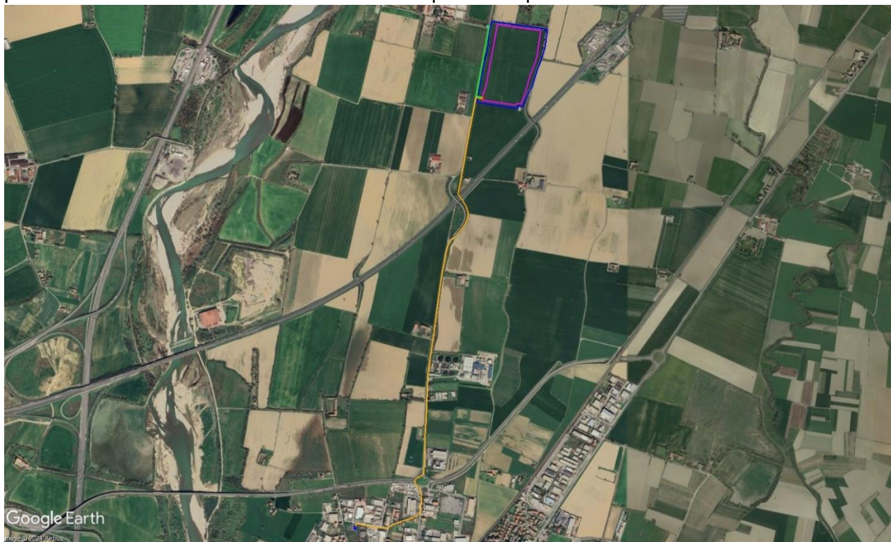
Figura 4 – Localizzazione dell'area di intervento su ortofoto, indicazione del percorso di connessione interrato previsto (linea arancione) su Cabina Primaria "Tortona" e richiusura linea MT (linea verde) su cabina secondaria.
